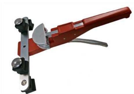
При необходимости, держа собранный трубогиб толкателем вверх, оттяните рукоятку храпового механизма от корпуса, пока толкатель не займёт крайнее нижнее положение. Поместите изгибаемую трубу в выемки упоров и, придерживая трубу, несколько раз нажмите на рукоятку храпового механизма, пока насадка не войдёт в плотное соприкосновение с изгибаемой трубой. Нажимая на рукоятку храпового механизма, изгибайте трубу до нужного угла.
