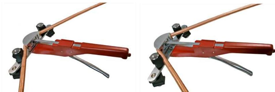
Для извлечения изогнутой трубки оттяните рукоятку храпового механизма от корпуса и вручную отведите от трубы насадку. После завершения работы разъедините трубогиб с перекладиной с упорами, очистите все использованные в работе части трубогиба BC-TB-56S *becool* при помощи куска чистой хлопчатобумажной ткани, смажьте зубчатую рейку тонким слоем солидола или другой консистентной смазки, после чего положите трубогиб и использовавшиеся при работе части в кейс.
