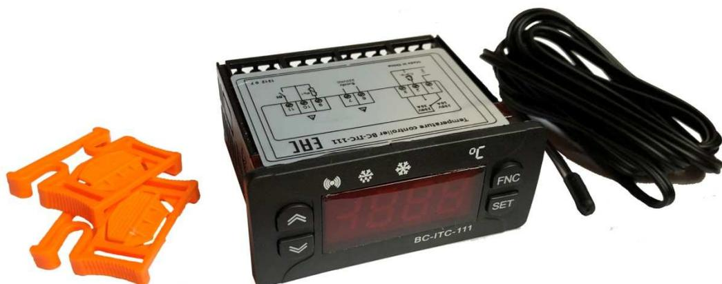
**BC-ITC-111** – Однорелейный контроллер температуры с функцией управления охлаждением и размораживанием естественным способом; одним температурным NTC-датчиком в охлаждаемом объёме; и дискретным входом контроля закрытия двери.
