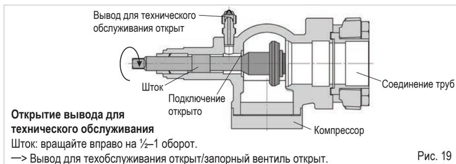
После вращения штока всегда устанавливайте защитный колпачок штока и затягивайте его моментом затяжки 14–16 Нм. В режиме работы он служит вторым уплотнительным элементом.
