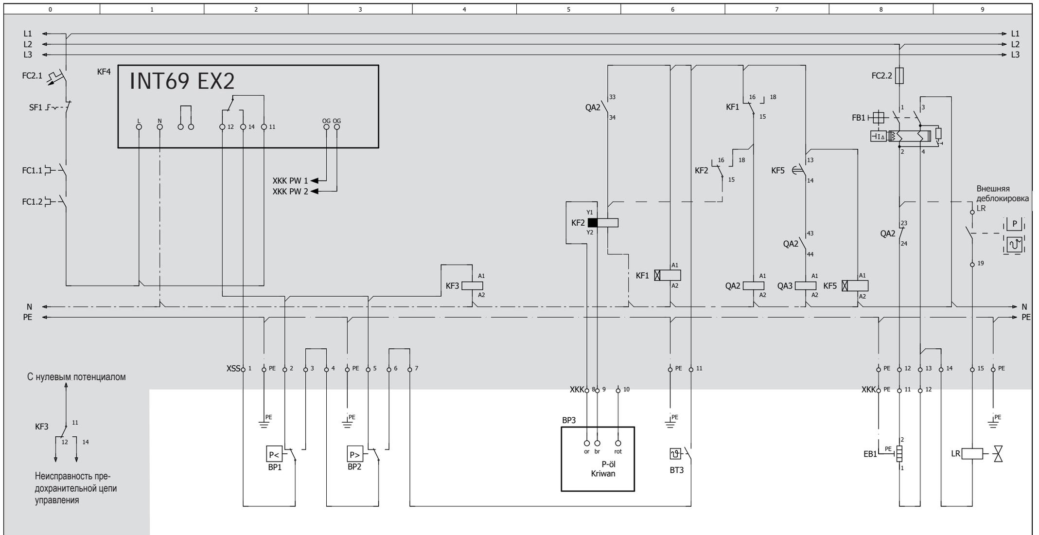
Электрическая схема является только системной схемой для построения и определения последовательности предохранительной цепи управления, без сообщений о неисправности и монтажной схемы (внутри или за пределами взрывоопасной зоны).
