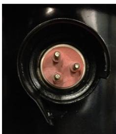
Рис. 8: Клеммы электродвигателя
