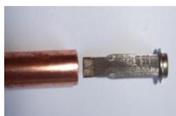
Сетчатый фильтр должен быть установлен в трубке, идущем под углом  $90^\circ$  к штоку клапана. Узкая шайба, закреплённая на сетчатом фильтре, упирается в край трубки и предотвращает падение фильтра внутрь (см. фото). Труба, идущая от центра верхней крышки компрессора, должна быть обжата таким образом, чтобы закрывать сетчатый фильтр и затем запаяна в этом положении.
