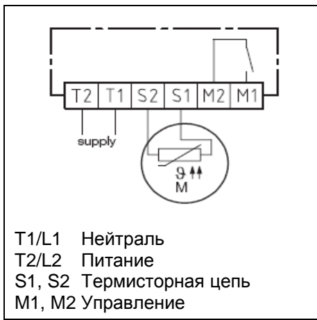
Рис. 14: Подключение модуля защиты
