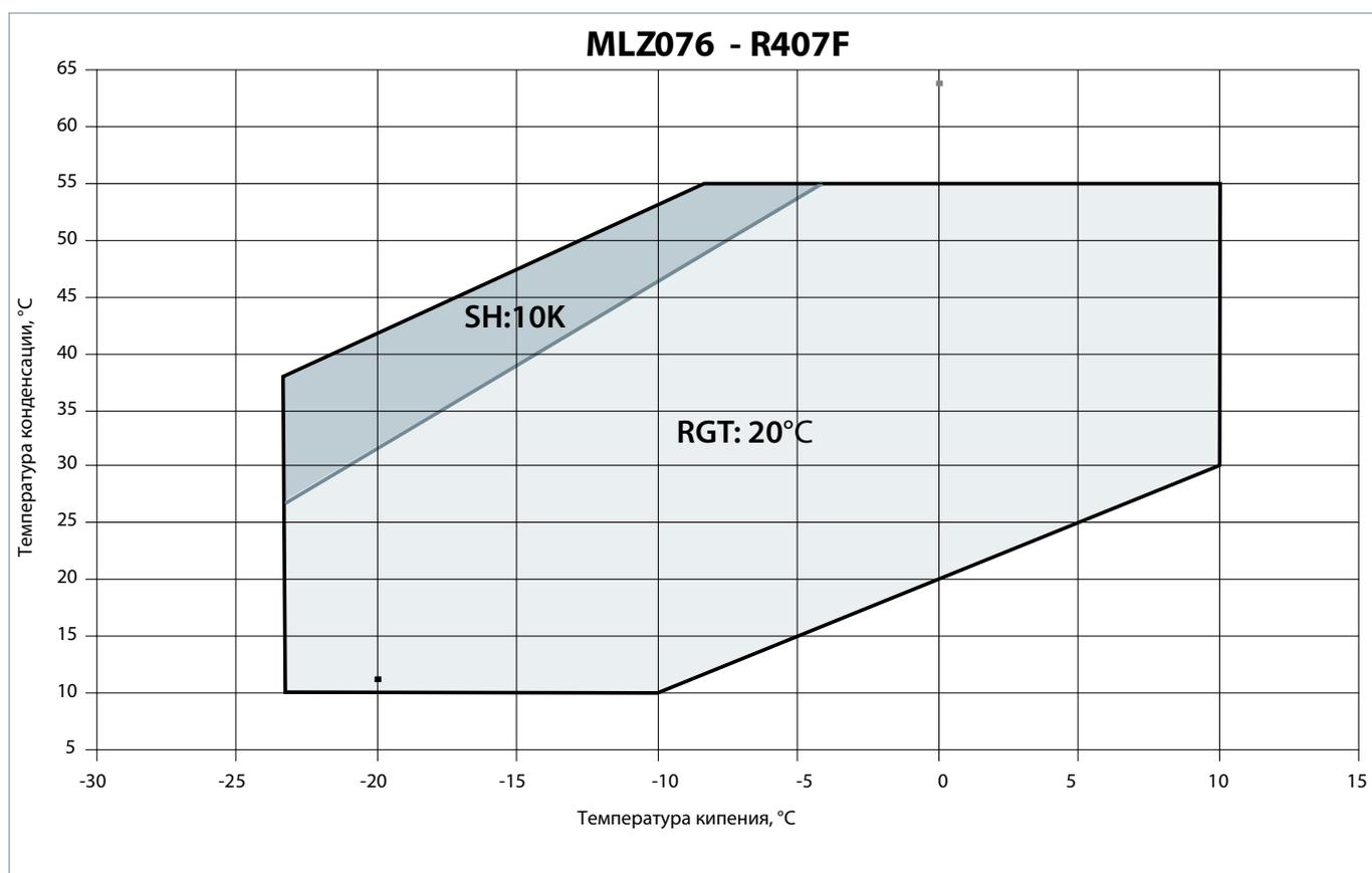
**Максимальная температура газа на линии нагнетания**
