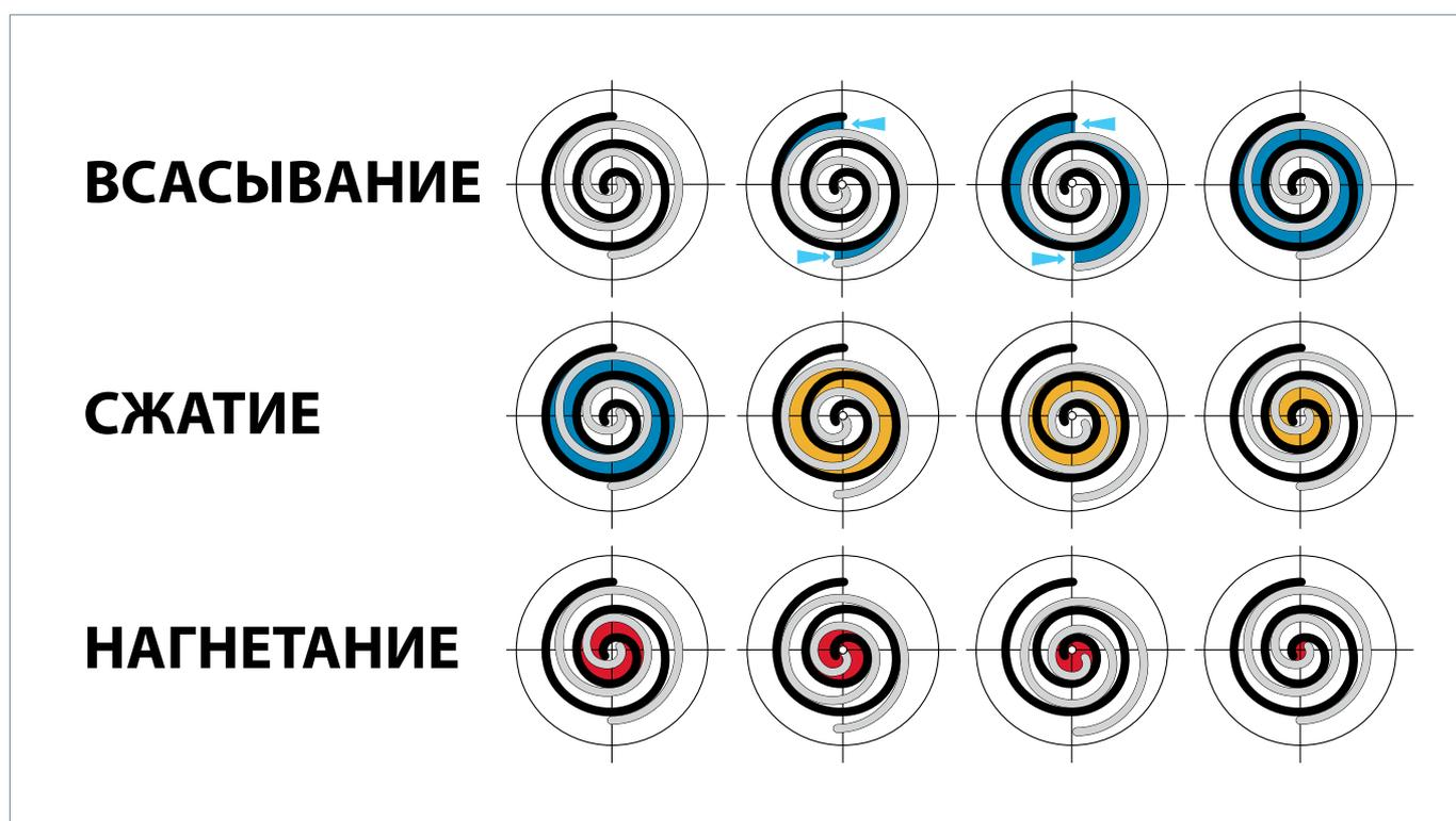
Спиральные компрессоры Данфосс изготавливаются с использованием современного станочного парка, передовых приемов сборки и контроля процессов обработки. При разработке компрессора и заводского оборудования основное внимание
