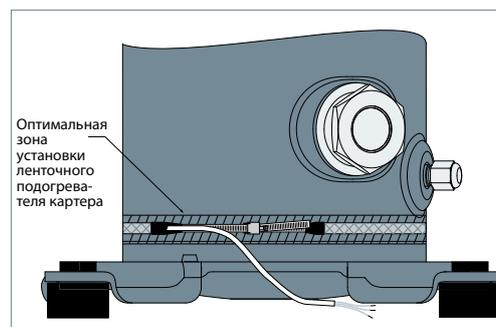
Подогреватели картера ленточного типа можно приобрести в компании Данфосс (см. стр. 41). Подогреватель картера должен быть включен, даже когда компрессор не работает.
