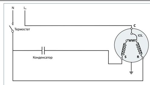
**Схема подключения типа PTCSRC**
