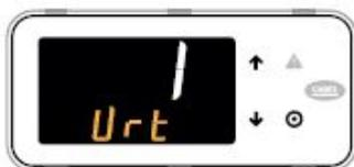
4. Нажмите клавишу «PRG» чтобы сохранить выбранное значение параметра (символ гаечного ключа исчезнет в поле текущего параметра, а значение параметра перестанет мигать).
