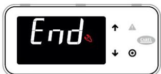
7. Нажмите клавишу «PRG» для завершения работы мастера конфигурации. Символ гаечного ключа исчезнет, что будет означать успешное завершение процедуры конфигурации.
