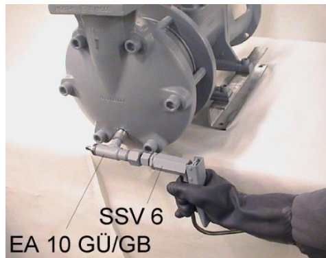
Рисунок 13-1 Слив масла через запорный и быстродействующий клапан
