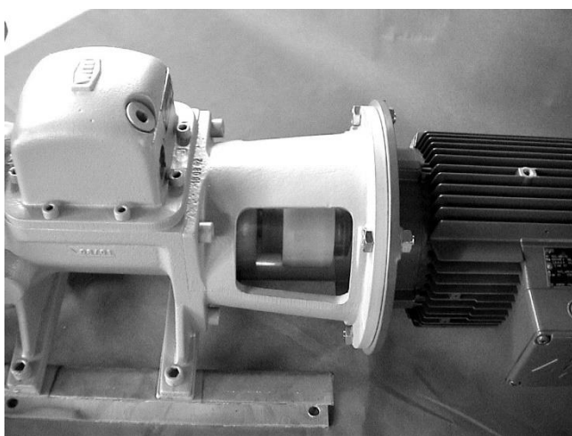
Рисунок 12-1 Установленный защитный кожух муфты
