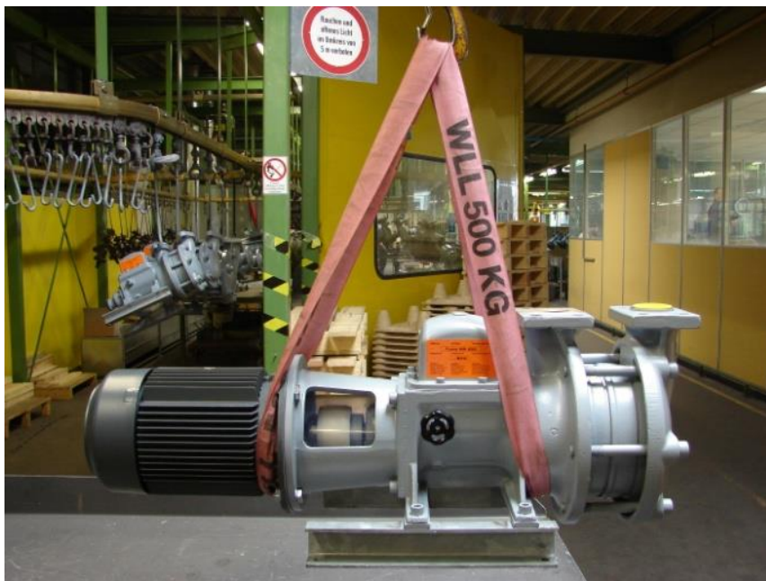
Рисунок 7-1 Поднятие насоса для хладагента типа GP
