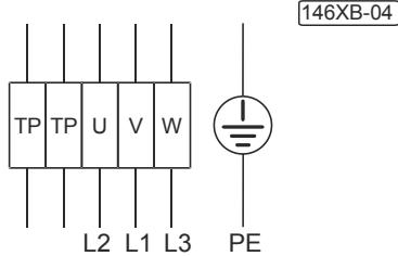
Prüfspannung bei Temperaturfühler max. 2,5V.
