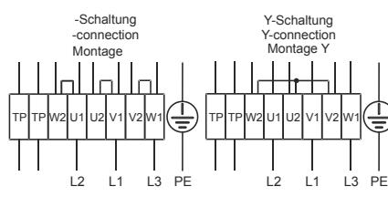
Prüfspannung bei Temperaturfühler max. 2,5V.
